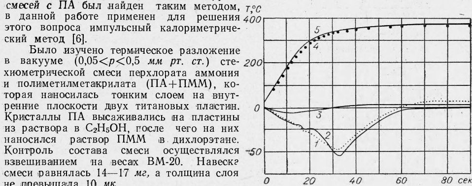
Рис. 1. Разложение ПА, ПММ и их смеси при монотонном нагреве.
