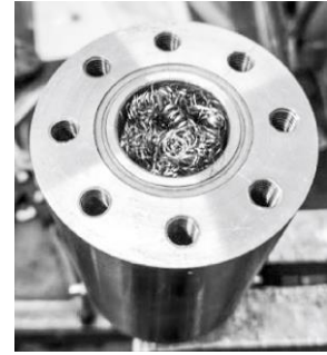
Рис. 9. Фотография демпфирующего слоя из металлической стружки в адсорбере.
