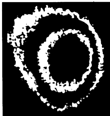
Рис. 5. Интерференционные полосы, соответствующие двум изолиниям профиля поверхности
