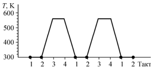
Рис. 2. Последовательность тактов при фиксации температуры.
