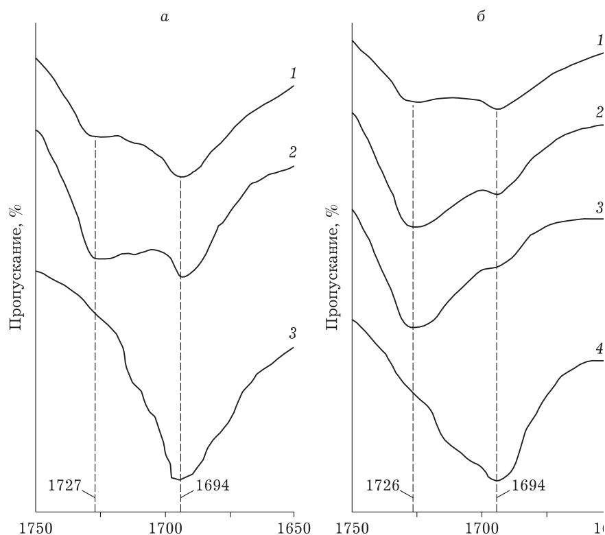
Рис. 5. Изменение полос поглощения валентных колебаний С=О-группы в ИК-спектрах mechanoактивированных реакционных смесей в зависимости от режима проведения mechанохимических реакций – времени mechанообработки ( \tau_{MO} ) и общей массы реакционной смеси ( m_{PC} ): а – смесь ( орто -хлорбензойная кислота + ПЭГ-6000) (1, 2); орто -хлорбензойная кислота (3). Условия mechанообработки: 1 – m_{PC} = 2.0 г, \tau_{MO} = 5 мин; 2 – m_{PC} = 2.0 г, \tau_{MO} = 10 мин; б – смесь ( мета -нитробензойная кислота + ПЭГ-6000) (1, 2, 3); мета -нитробензойная кислота (4). Условия mechанообработки: 1 – m_{PC} = 2.0 г, \tau_{MO} = 5 мин; 2 – m_{PC} = 1.0 г, \tau_{MO} = 5 мин; 3 – m_{PC} = 1.0 г, \tau_{MO} = 10 мин. Обозн. см. рис. 2.
