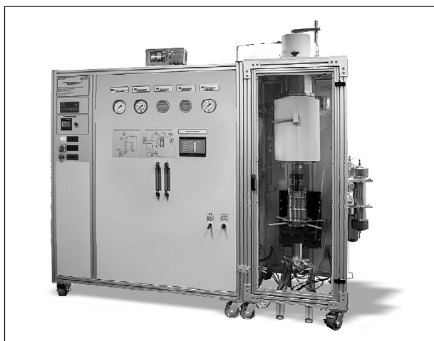
Рис. 1. Установка УИДК для исследования прочностных свойств керна в пластовых условиях производства АО «Геологика».
