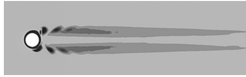
Рис. 4. Мгновенное поле завихренности в случае обтекания вязкой жидкостью осциллирующего цилиндра при \alpha = 4 и f = 4 .
