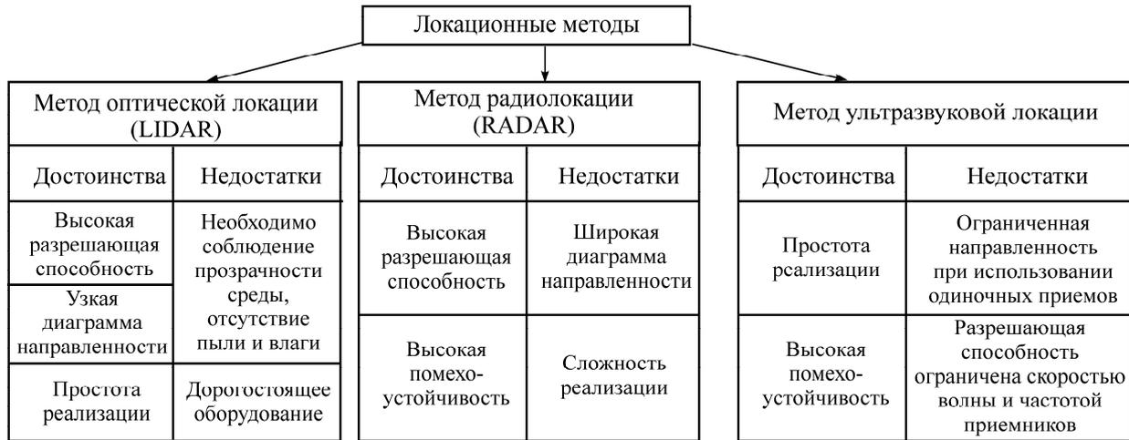
Рис. 4. Локационные методы определения конвергенции горных выработок
