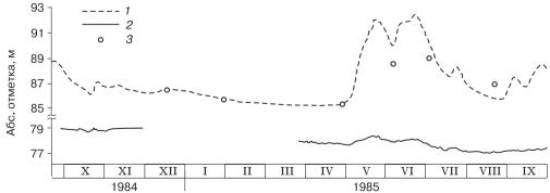
Рис. 4. График изменения уровня воды в р. Лене (1) и в скважинах, оборудованных на нижнесреднекембрийский водоносный комплекс на высокой пойме р. Лены (2) и на о. Песчаный (3).
