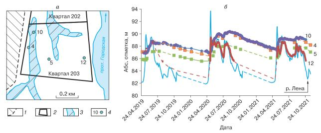
Рис. 3. Схема расположения наблюдательных гидрогеологических скважин (a) и график изменения уровня надмерзлотных грунтовых вод на пойменно-намывной территории г. Якутска и р. Лене (гидропост г. Якутск) в 2019–2021 гг. ( $\delta$ ).
