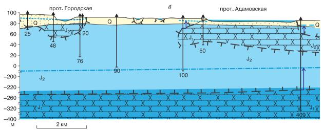
Рис. 2. Схема расположения скважин (a) и гидрогеологический разрез поймы р. Лены у г. Якутска ( $\delta$ ).
