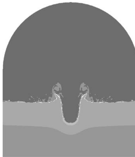
Рис. 5. Соударение струи с преградой в момент времени 71.95 мкс (расчет)
