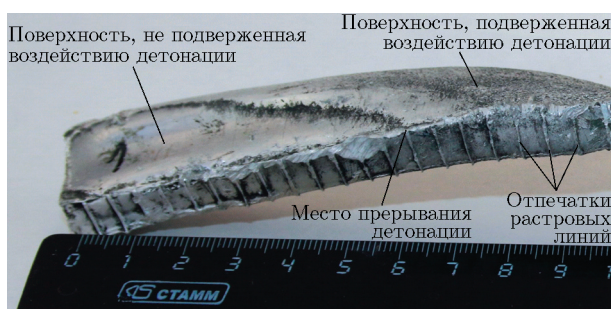
Рис. 8. Фотография фрагмента алюминиевой пластины после опыта
