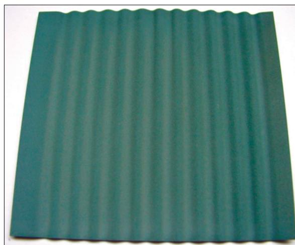
Рис. 8. Образец интегрального сепаратора/интерконнектора с каталитическим покрытием Ni/La-Mg-( $\gamma + 25\chi$ )-Al<sub>2</sub>O<sub>3</sub>.
