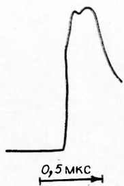
Рис. 6. Типичная запись яркости излучения в дибромметане, полученная при высоких давлениях ( u_0 = 2,39 км/с).
