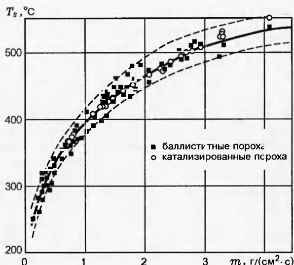
Рис. 2. Объединенная зависимость температуры горячей поверхности T_s от массовой скорости горения m для простых и нитраминсодержащих баллиститных порохов:
