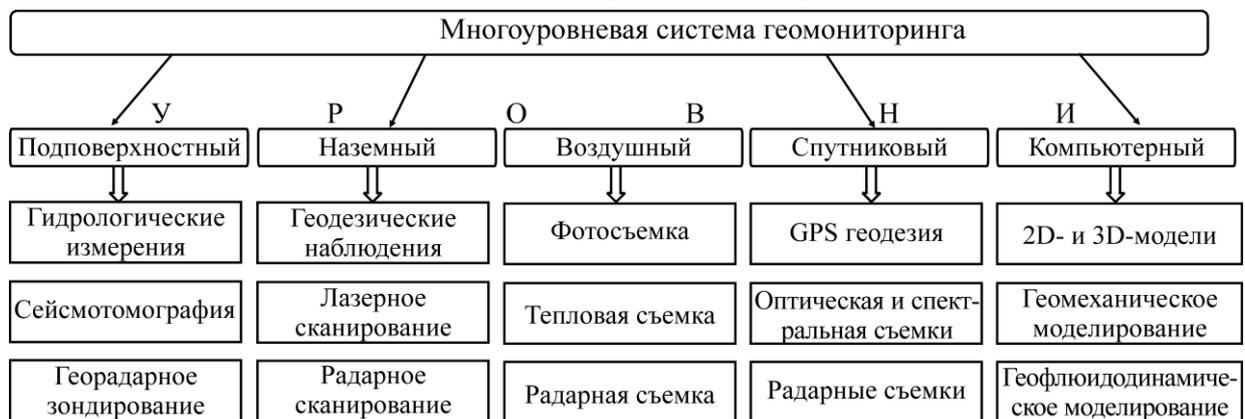
Рис. 2. Системная структура комплексного многоуровневого геомониторинга природно-технических объектов
