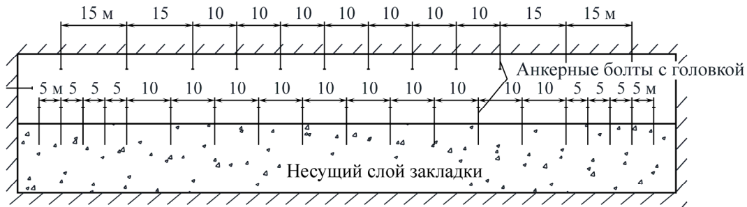
Рис. 2. Схема расположения реперов профильной линии в кровле и почве ленты 33 слоя 4 на отм. – 230 м (разрез вдоль ленты 33, см. вид А на рис. 1)
