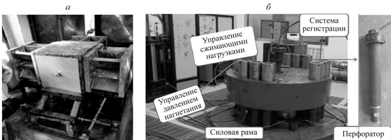
Рис. 3. Установки для исследования процесса гидроразрыва в Уханьском технологическом университете (а) и Научно-исследовательском институте по разведке и разработке нефти (б) [18, 19]
