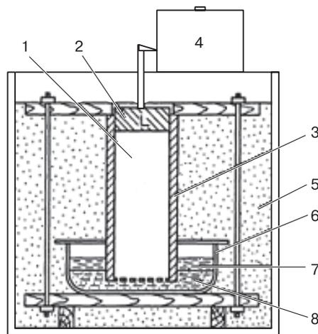
Рис. 3. Устройство для промораживания образца грунта [Taber, 1930].
