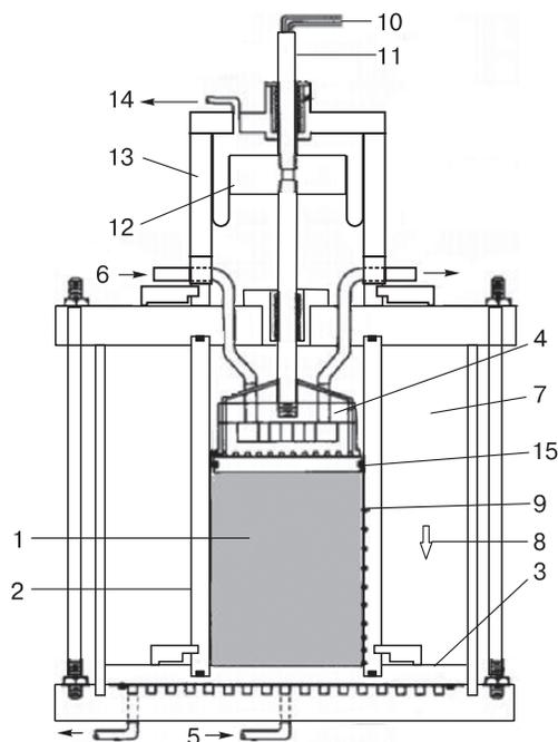
Рис. 6. Схема морозильной камеры [Penner, 1986].
