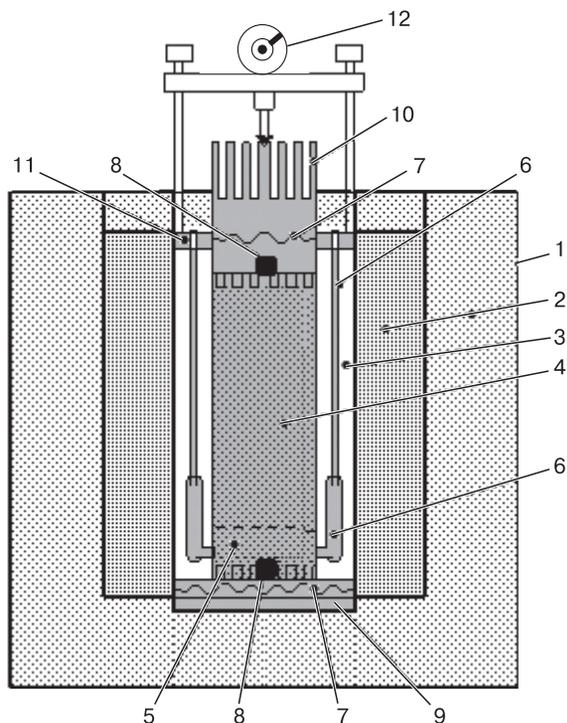
**Рис. 4. Измеритель пучинистости грунтов [Лашин, Ганелес, 1979].**
