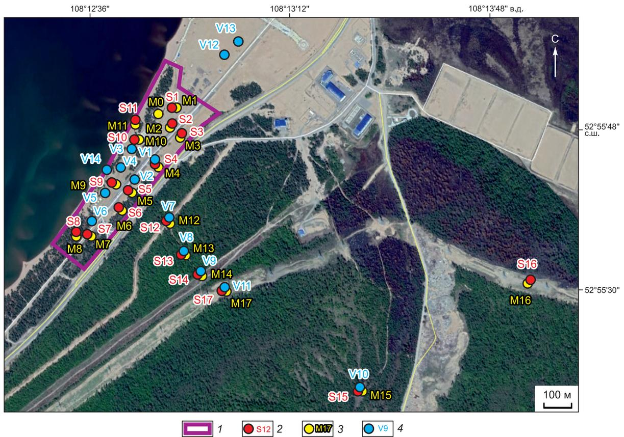
**Рис. 3.** Общая схема инструментальных измерений на участке исследований (обозначен звездочкой на рис. 2, а). 1 – граница участка работ, 2 – точка сейсмозондирования и ее номер, 3 – точка регистрации микросейсм и ее номер, 4 – точка ВЭС и ее номер.
