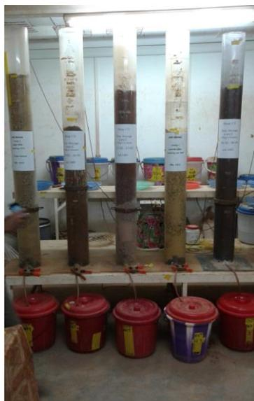
Рис. 1. Процесс колонного выщелачивания
