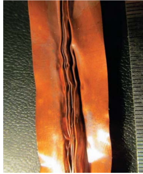
Рис. 4. Потеря устойчивости при сжатии медного проводника собственным магнитным полем
