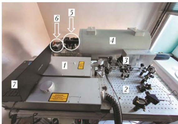
Рис. 1. Лидарная система: 1 – ПГС; 2 – оптические, оптомеханические элементы и юстировочный лазер Thorlabs, расположенные на общем основании соосно с выходным излучением ПГС; 3 – зеркальный коллиматор; 4 – приемный телескоп; 5 – оптические и оптомеханические элементы и фотодетекторы Thorlabs; 6 – USB-осциллографы для регистрации лидарных и опорных сигналов; 7 – персональный компьютер (см. цветные рисунки на сайте http://iao.ru/ru/content/vol.38-2025/iss.5 )
