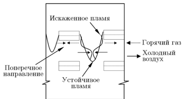
Рис. 5. Искажение пламени из-за гидродинамической неустойчивости (по горизонтали)
