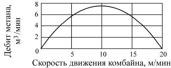
Рис. 3. Параболическая зависимость метановыделения от скорости движения очистного комбайна
