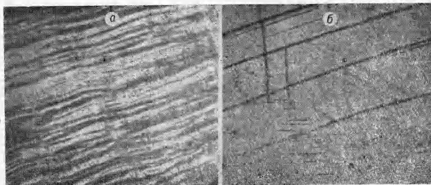
Рис. 5. Сталь Г13Л у поверхности (а) и на расстоянии 4 мм от поверхности (б) после наката роликом. \times 1200 .
