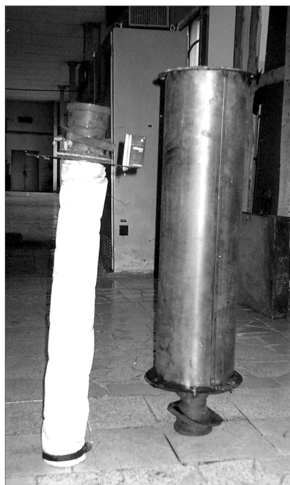
Рис. 4. Внешний вид нейтрализатора с радиальным ходом газов (справа) и каталитической стеклоткани.
