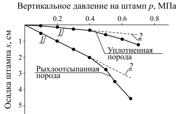
Рис. 3. Зависимость осадки штампа от давления S=f(p) : 1 — линейная часть графика; 2 — осредняющая прямая
