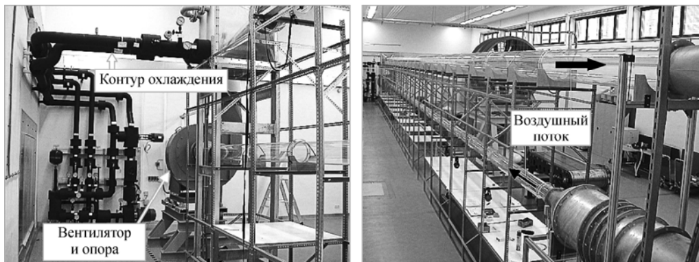
Рис. 1. Установка CoLaPipe Отделения аэродинамики и механики сплошной среды (Коттбус-Сенфтенберг).
