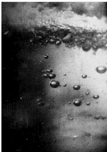
Рис. 1. Образование метастабильного перегретого слоя пены при кратковременном нагреве электрической спиралью воды, загущенной 3 % полиакриламида (температура в пенном слое 540 К)
