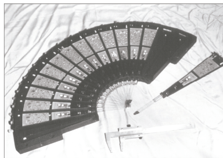
Рис. 7. Первый быстрый сцинтилляционный однокоординатный рентгеновский детектор для цифровой разностной ангиографии на синхротронном излучении (пространственное разрешение 1,5 мм, число каналов 128, скорость счета 128×1 МГц)
