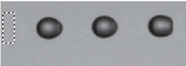
Рис. 7. Область распада струи (выделенная область — область, в которой подсчитывалось количество переключений яркости)
