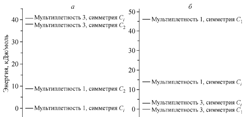
Рис. 4. Относительные энергии оптимизированных комплексов \text{Eu}_2(\text{C}_2\text{H}_5\text{—C}_5\text{H}_3\text{N—C}_6\text{H}_4\text{—CN})_2 (а) и \text{Eu}(\text{C}_2\text{H}_5\text{—C}_5\text{H}_3\text{N—C}_6\text{H}_4\text{—CN})_2 (б)
