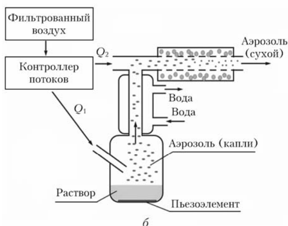
Рис. 1. Генератор аэрозольных частиц: общий вид ( а ); принципиальная схема блока генерации аэрозоля с осушителем ( б )
