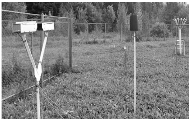
Рис. 1. Осадкомеры (слева направо) ОПТИОС, RC и О-1 на метеоплощадке ГО ИМКЭС
