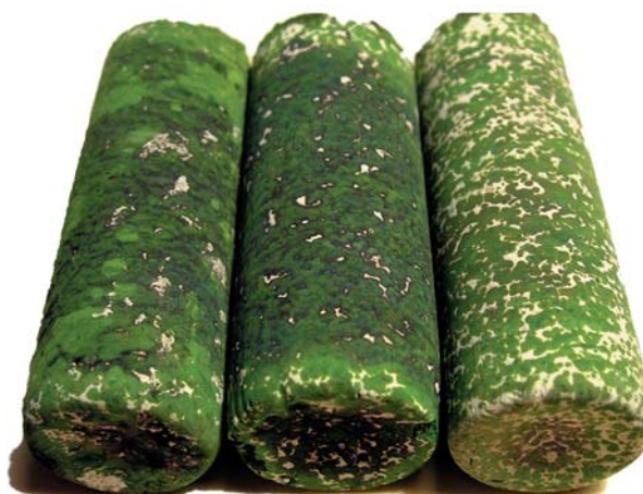
Рис. 2. Продукты горения смеси \text{CrO}_3 + \alpha\text{AlN} после горения (слева направо \alpha = 1, 2, 3 )
