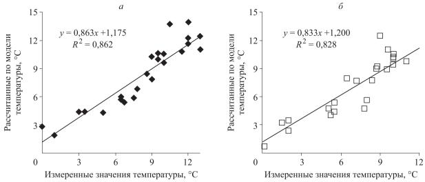
*Рис. 3.* Сравнение измеренных и рассчитанных по моделям (2) и (3) почвенных температур на глубине 40 (a) и 60 см  $(\delta)$ .
