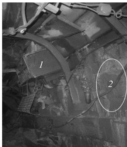
Рис. 7. Место установки энергетической ловушки (1) на борту орта вблизи ВДПУ (2)
