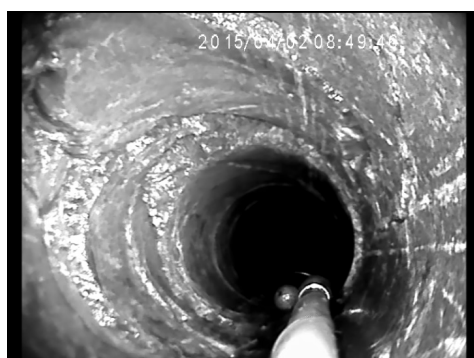
Рис. 1. Зона нарушенности пород, выявленная в горизонтальной скважине № 1С диаметром 59 мм на расстоянии 5.5 м от устья скважины, рудник “Таштагольский”
