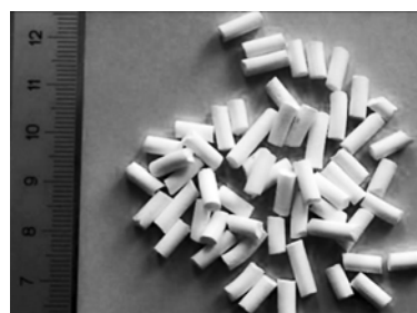
Рис. 2. Фотография гранул композитного сорбента.
