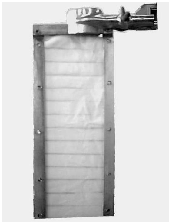
Рис. 1. Устройство для проведения «вертикального теста» с образцом ткани, обработанной перед экспериментом
