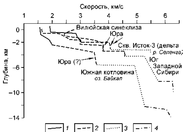
Рис. 7. Типичные графики зависимости скорости от глубины в осадочных бассейнах окрестности Сибирской платформы и под Южной котловиной оз. Байкал по данным скважинных и сейсмических наблюдений и предполагаемый возраст комплексов пород.
