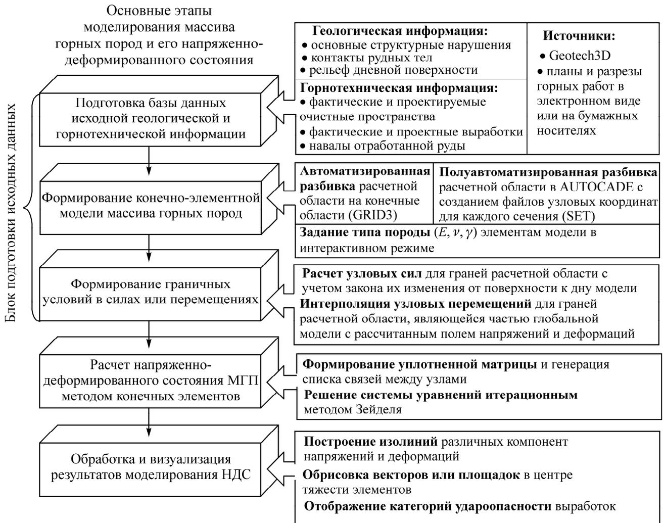
Рис. 1. Блок-схема программного комплекса SigmaGT:  $E$  — модуль Юнга;  $\nu$  — коэффициент Пуассона;  $\gamma$  — объемный вес
