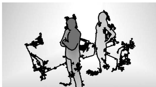
Рис. 2. Зашумлённое дальностное изображение (чёрным отмечены пиксели с неопределённой глубиной)
