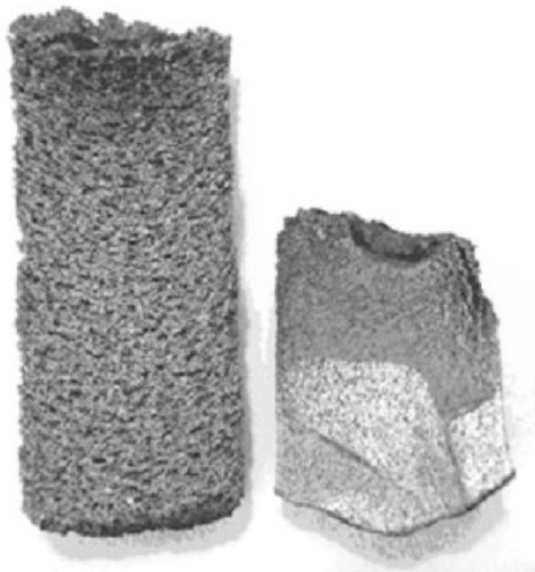
Рис. 6. Фотография продольных разрезов конденсированных продуктов горения смеси Ti + 0.5C (сажа):
