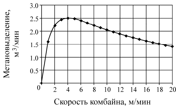
Рис. 2. Теоретическая зависимость дебита метана от скорости движения очистного комбайна по лаве
