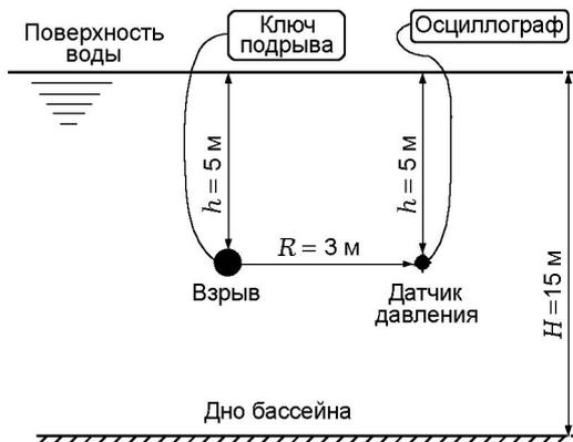
Рис. 3. Схема постановки экспериментов
