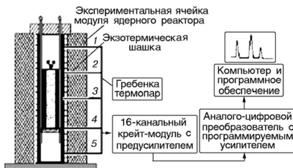
Рис. 6. Схема размещения термопар (1–5) по длине трубы и определения динамики температуры
