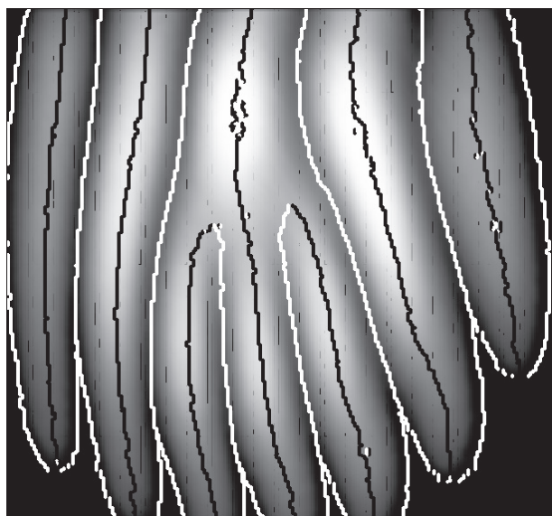
Рис. 4. Распределение экстремумов, полученное в результате фильтрации. Черные точки – максимумы, белые точки – минимумы в обработанной интерферограмме
