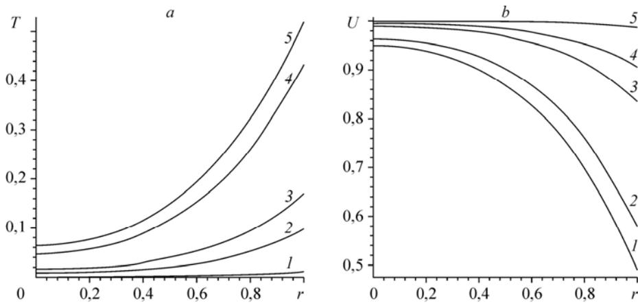
Рис. 2. Неравномерность профилей температуры и влагосодержания в зерне в зависимости от радиуса.
