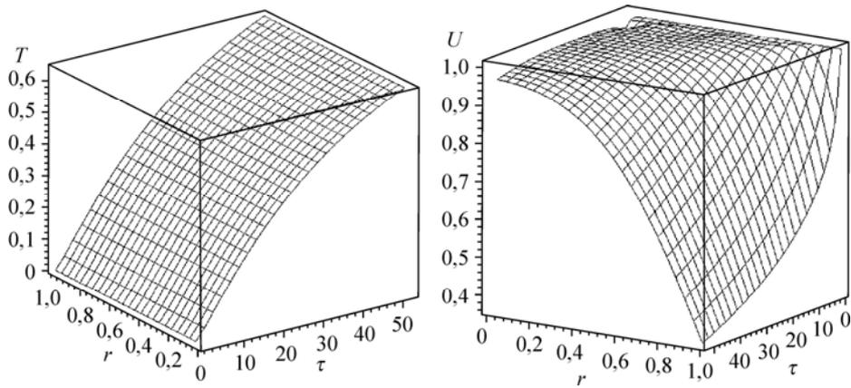
Рис. 4. Распределения температуры и влагосодержания по экспериментальным данным.
