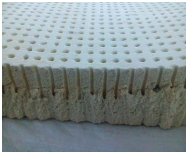
Рис. 1. Фотография пены из натурального каучука плотностью 110 \text{ кг/м}^3
