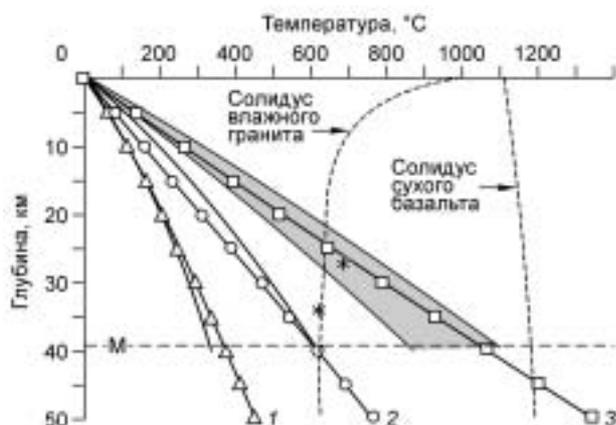
**Рис. 6. Геотермы и средняя граница М регионов США в сравнении с данными о плавлении гранита и базальта [22].**
